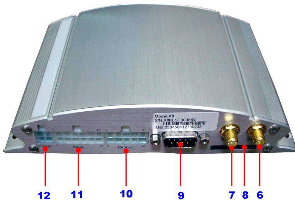
6. 衛星 GPS 外接天線(SMA 接頭)
